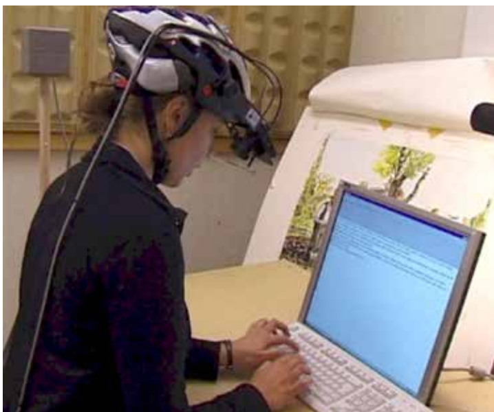
Exempel på hur vi mäter ögonrörelser och spelar in tangentslag för att undersöka hur läsning och skrivning hänger samman.
